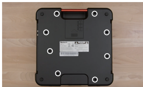
2) PT-01 Scratch本体裏のネジ(8箇所)を取り外します。
