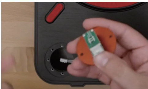
1) 純正搭載されているスクラッチスイッチ部のネジを外し、接続コネクタから取り外して下さい。
