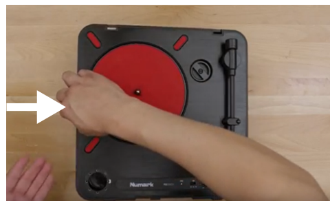
3) 本体を表向きに戻し、左サイドより上部パーツをゆっくりと引き上げ、内部が確認出来る位置で止めて下さい。
