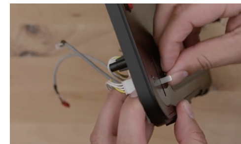
8) JDDX2RSのフェイスプレートをマウントしたJDDX2RSのネジ穴に合せ、付属ネジ2本で止めて下さい。
